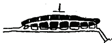
图 2-3-53 靠近上盘矿体内环形布置
