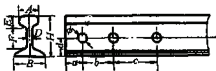
图 1-3-16 钢轨主要尺寸示意图
