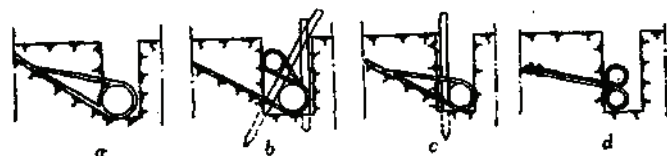
图 1-12-43 人工绳窝结构形式
