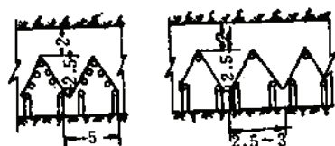
图 2-5-15 非封闭式翼状假底
