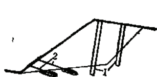
图 2-2-44 钢筋混凝土桩配锚杆 1—钢筋混凝土桩; 2—锚杆
