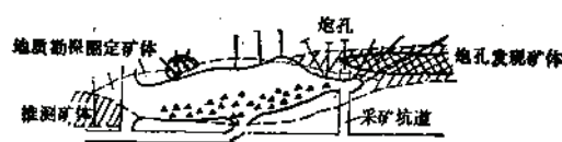
图 1-7-21 用爆破孔对采场壁探矿图
