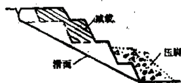
图 2-2-43 减载压脚布置示意图
