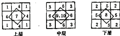
图 1-10-29 某斑岩铜矿数据分组图 块中数字代表该超级块中数据分组的权号
