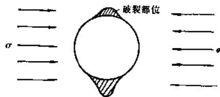
图 2-1-41 主应力方向与破裂部位的关系
