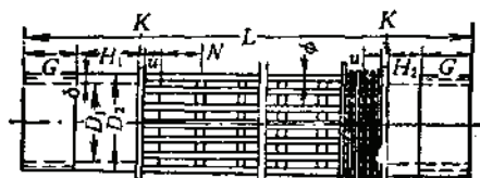
图 3-4-15 钢筋骨架缠丝过滤器
