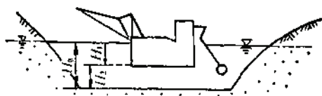
图3-2-1 采掘船漂浮深度示意图
